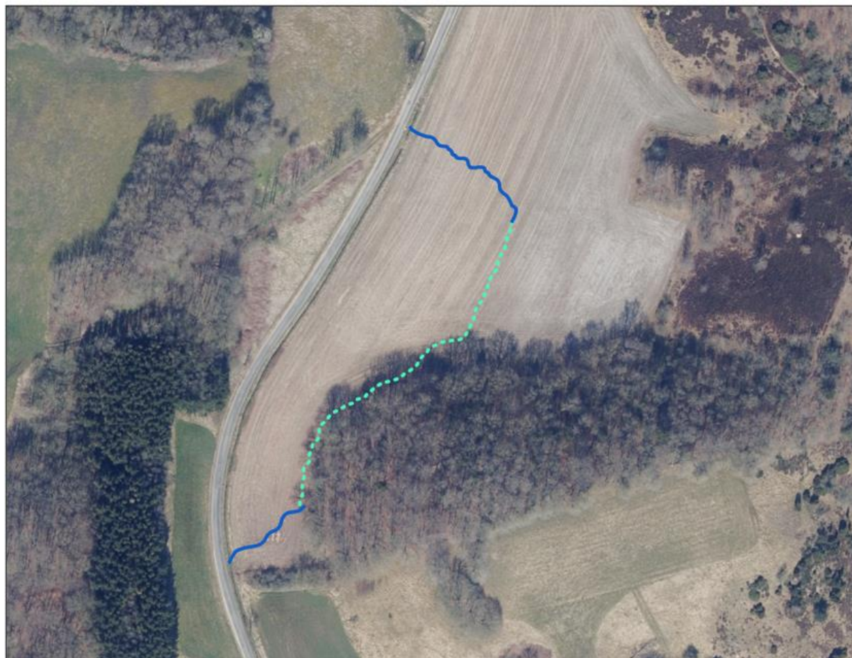
Figur 3-1 De projekterede tiltag. Den blå linje er stræk, hvor der graves et vandløbsprofil, hvorimod den stiplede linje er stræk, hvor vandet skal finde sin "egen vej".
