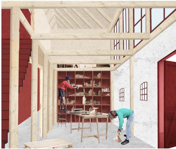
Lade omdannet til fælles kontorer og værksted. Tagkonstruktionen er hævet for at tilføje vinduer og øge lysindfald. Aaben Studio, Nikita Gyawali
