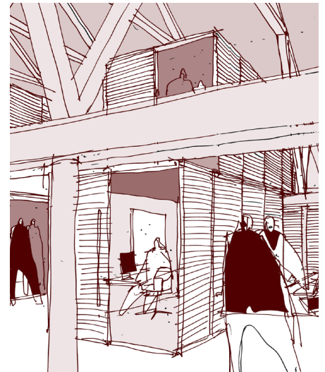
Kig ind i en genanvendt landbrugsbygning. Den ydre skal er den bærende konstruktion. Nyt modulært system. Blicon, Jørgen Gehl
